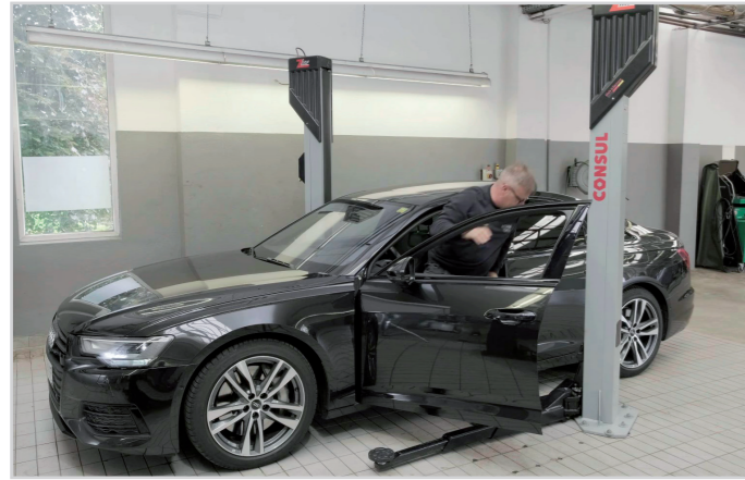
Die versetzt stehenden Säulen ermöglichen ein problemloses Öffnen der Fahrertür. The offset placed posts allow for an unproblematic opening of the driver's door.
